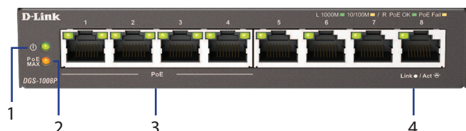
Slika 1: LED lampice na prednjoj ploči
