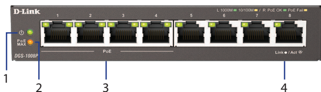
Afbeelding 1: ledlampjes op het voorpaneel
