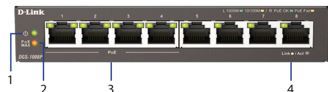
Εικόνα 1: Ενδείξεις LED στο εμπρός πάνελ
