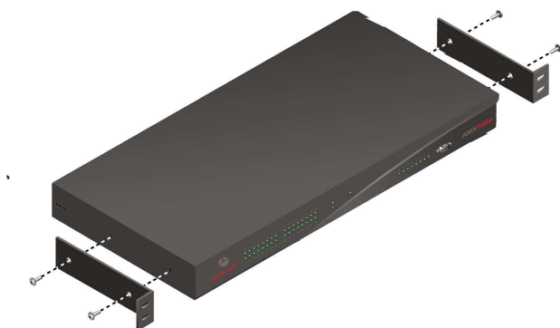
Figure 2.4 : Schéma de montage en rack du commutateur AMX5000
