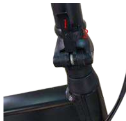
Rode o anel de segurança (2) para impedir o desbloqueio acidental da patilha de fixação (1).
