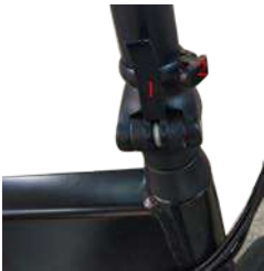
Den Sperrhebel (1) von unten nach oben bewegen, um ihn zu schließen
