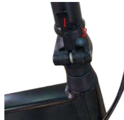
Den Sicherungsring (2) drehen, um eine unbeabsichtigte Auslösung des Befestigungshebels (1) zu verhindern.
