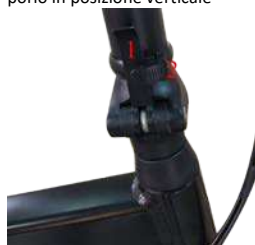
Ruotare l'anello di sicurezza (2) per impedire lo sblocco accidentale della leva di fissaggio (1).
